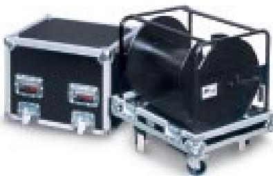
Avvolgicavo montato su cuscinetti a sfera con frizione e manovella di recupero, in flight case con ruote frenanti diametro 100 mm montate su rinforzo in legno spessore 18 mm. Motorizzabile con "Power Reel".
