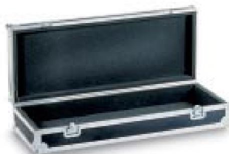
Flight-case per tastiera elettronica realizzato con legno multistrato fenolico sp. 11 mm, rivestimento interno in poliuretano sp. 20 mm, chiusure a farfalla e maniglie ad incasso con rinforzi interni.
